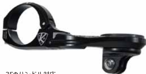
35Φハンドル対応 Edge500/200 シリーズ対応 GoPro スタイルマウント 6061-T6 アルミニウム
